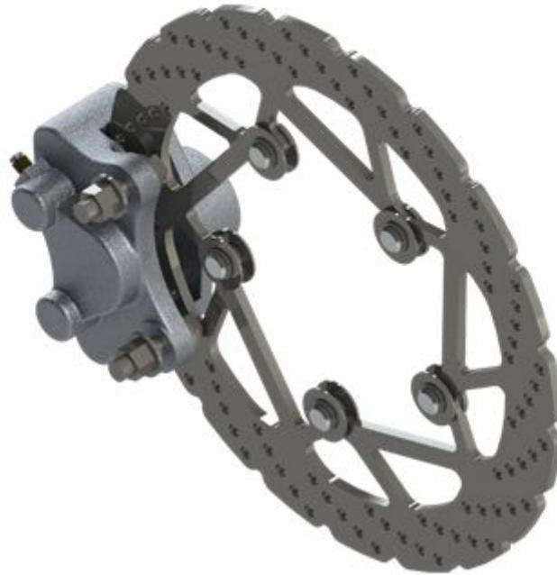
*Figura 7: Renderização do Projeto do Freio Hidráulico*
